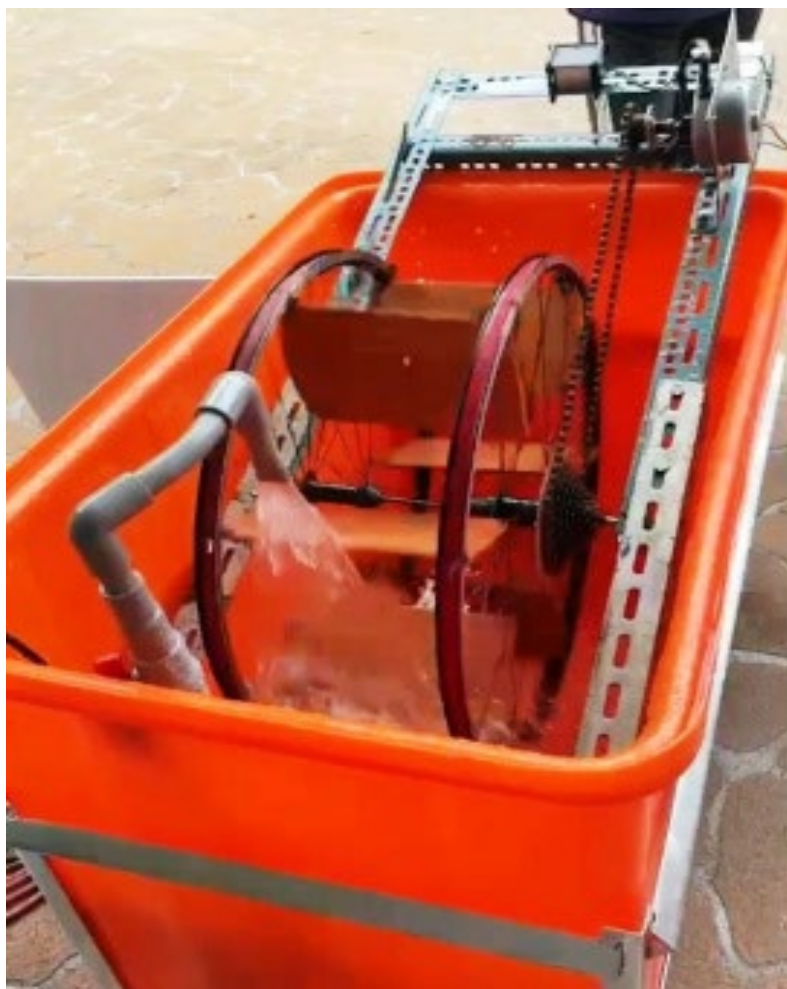
蕭瑞昌師生團隊研發的小型水力發電機。
